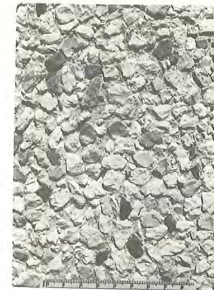
Figur 5.65: Betonoverflader med frilagte stenmaterialer; fin-kornet marmor (tv) og kalcineret flint (th)
